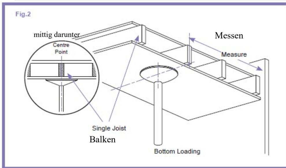
Balken laufen in der Regel im 90°Winkel zu den Dielen und werden in der Regel zwischen den beiden Wänden in einem Zimmer gelegt, die am nächsten zueinander sind. Balken können durch Antippen mit dem Knöchel oder mit einem optionalen Balken Finder gefunden werden.
