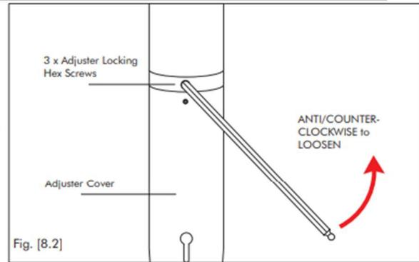
Lösen Sie nun die 3 Justierschraubenschrauben auf der Justierabdeckung mit dem 5mm Inbusschlüssel - mindestens 2 ganze Umdrehungen. (Entfernen Sie die Schrauben NICHT vollständig) und stellen Sie sicher, dass sich das X-Lock im statischen / nicht drehenden Modus befindet.
