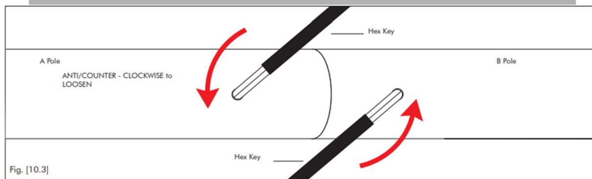
Legen Sie die Stangenrohre auf den Boden und lösen Sie die X-Joints, um die XPERT Pro zu zerlegen. Um das X-Joint zu lösen, drehen Sie beide Inbusschrauben gegen den Uhrzeigersinn - schrauben Sie die Schrauben raus, bis Druck auf den Schlüssel ausgeübt wird
