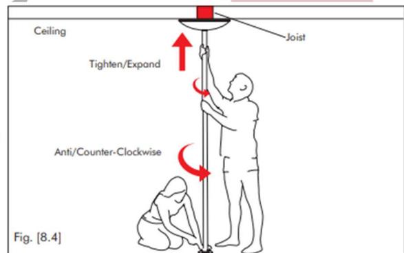
Sobald die Stange senkrecht steht und die zweite Person immer noch die Basis hält, drehen Sie die Pole gegen den Uhrzeigersinn (d. h. von links nach rechts), was die Pole verlängert, bis sie die Decke berührt.
