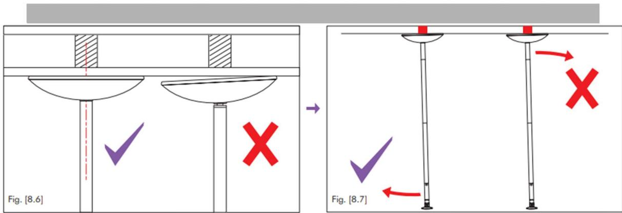
Es ist wichtig, dass die Deckenkuppel flach an der Decke / dem Balken anliegt. Verlängern Sie die Höhenschraube NICHT weiter, bis die Deckenkuppel flach an der Decke / dem Träger anliegt. Wenn die obere Kuppel nicht flach ist, kann sich die Platte drehen und die Decke verrutschen oder beschädigen.
