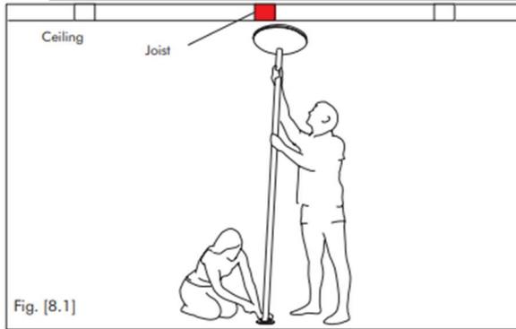
Mit einer Person, die die Basis hält, sollte die andere Person langsam und vorsichtig die Stange heben und sie hochziehen, bis sie vertikal und unter dem Balken steht. Nicht die Stange treten, um sie zu positionieren.
