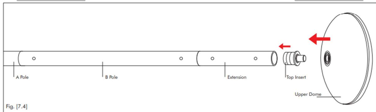
Sobald die A-Pole und die B-Pole (und alle zusätzlichen Verlängerungen/Extensions) verbunden sind, stecken Sie den Top Insert in die verwendete B-Pole oder die letzte Verlängerung und schieben Sie dann die Deckenkuppel auf den Top Insert. Seien Sie vorsichtig, wenn Sie die montierte Stange aufrichten, dass die Deckenkuppel nicht herunterfällt, wenn sie in Position gebracht wird.
