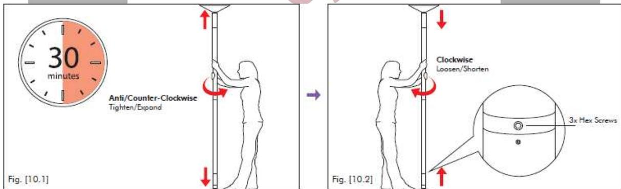
Weil die XPERT Pro-Stange Druck verwendet, um in Position zu bleiben, sollten der Druck und X-Joints regelmäßig während des Gebrauchs überprüft werden, idealerweise alle 30 Minuten.
