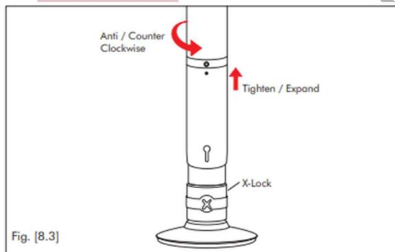
Pole Verlängerung: Durch Drehen der Hauptpole von links nach rechts (gegen den Uhrzeigersinn) wird die Pole verlängert / gespannt. Durch Drehen der Pole von rechts nach links (im Uhrzeigersinn) wird die Pole verkürzt / gelöst.
