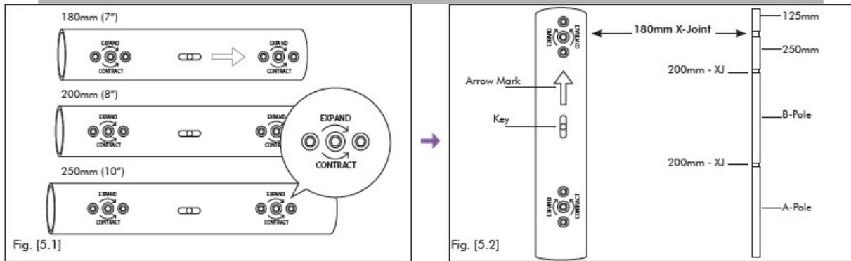
Die X-Pert Pole enthält (abhängig vom Durchmesser) die folgenden X-Joints:
