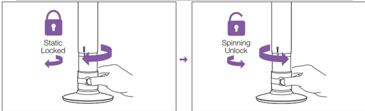
Um die XPERT Pro in den statischen Modus zu versetzen, drehen Sie den Gummigriff im Uhrzeigersinn.
